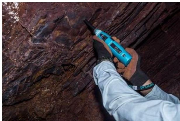
Figura 2: Exemplo de aplicação do martelo de Schmidt.
